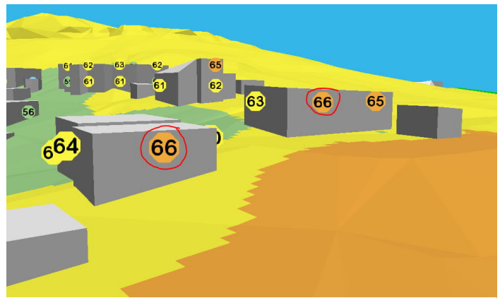
Figur 10. Bostad på fastighet Backa 145:3 (t.v.) och Backa 145:4 (t.h.). Siffrvärden avser ekvivalent ljudnivå från trafik i nuläget år 2024. Överskridanden av åtgärdsnivå för äldre befintlig bebyggelse är utritade med röd markering
